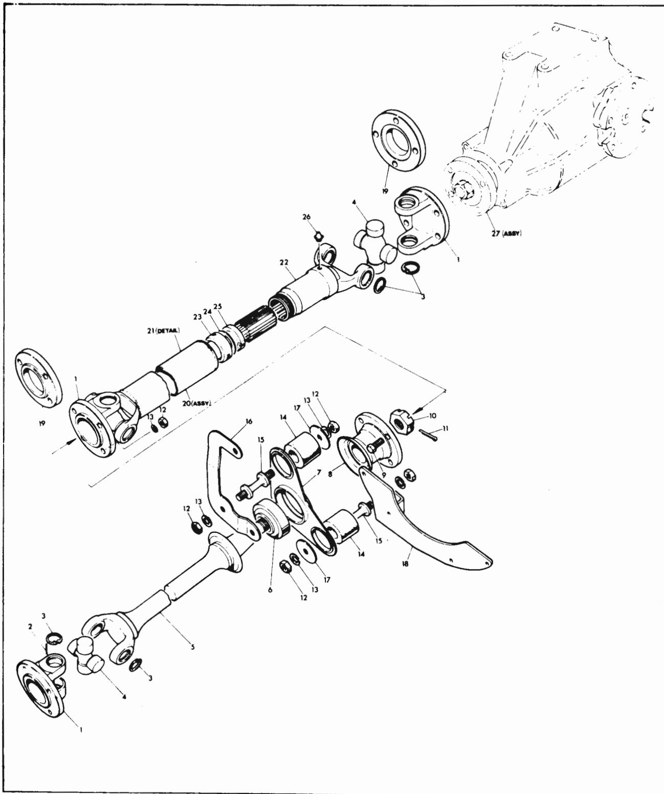
Fig. C.13 FRONT DRIVE SHAFTS - FF
