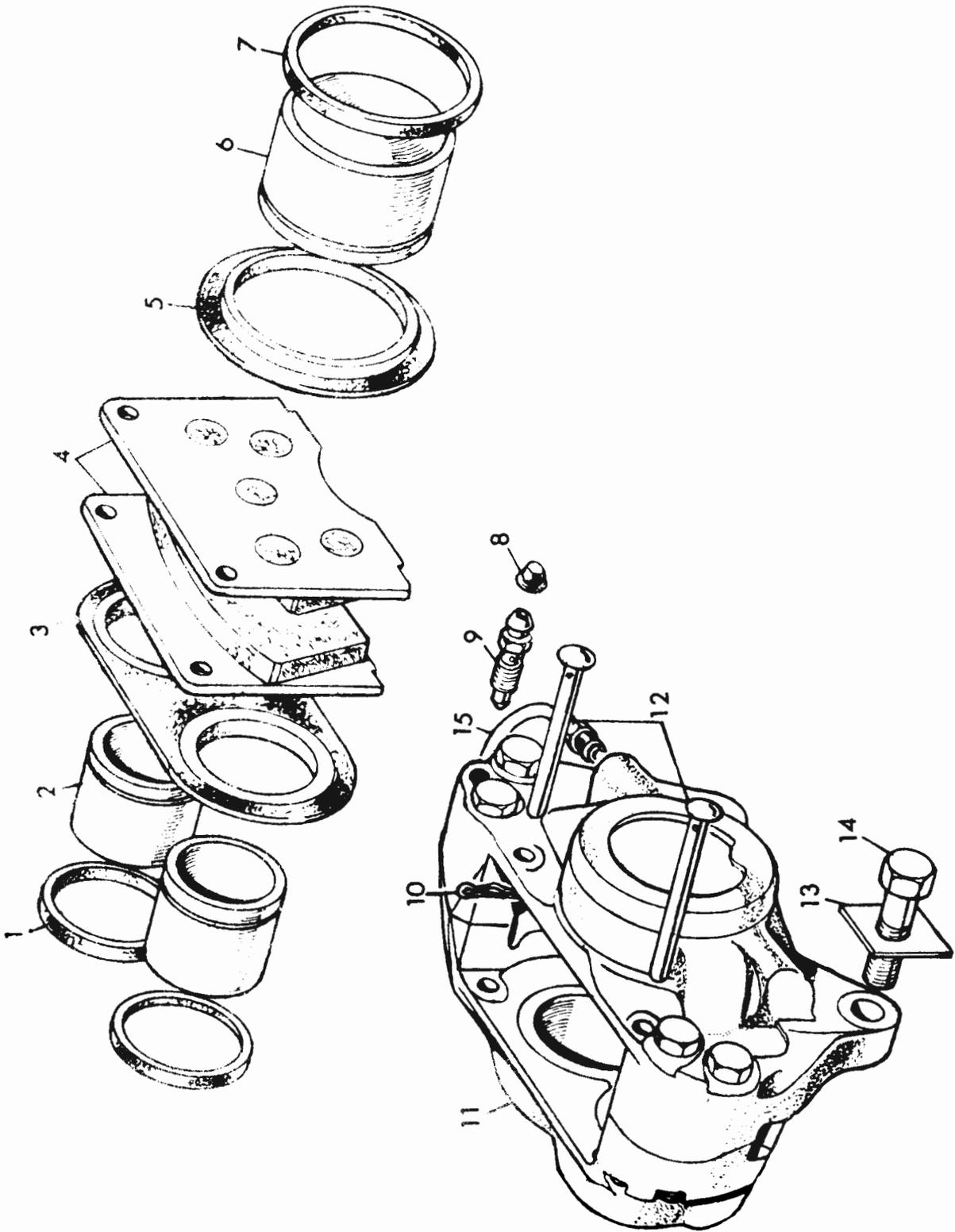
Fig. G.9 FRONT BRAKE UNITS
