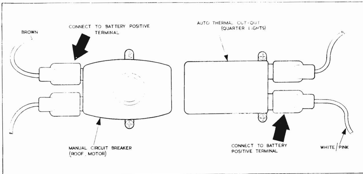
FIG. N12B. CONNECTION POINTS FOR SLAVE BATTERY
