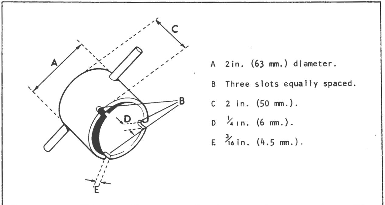
Fig. J.3 TOOL FOR TANK UNIT
