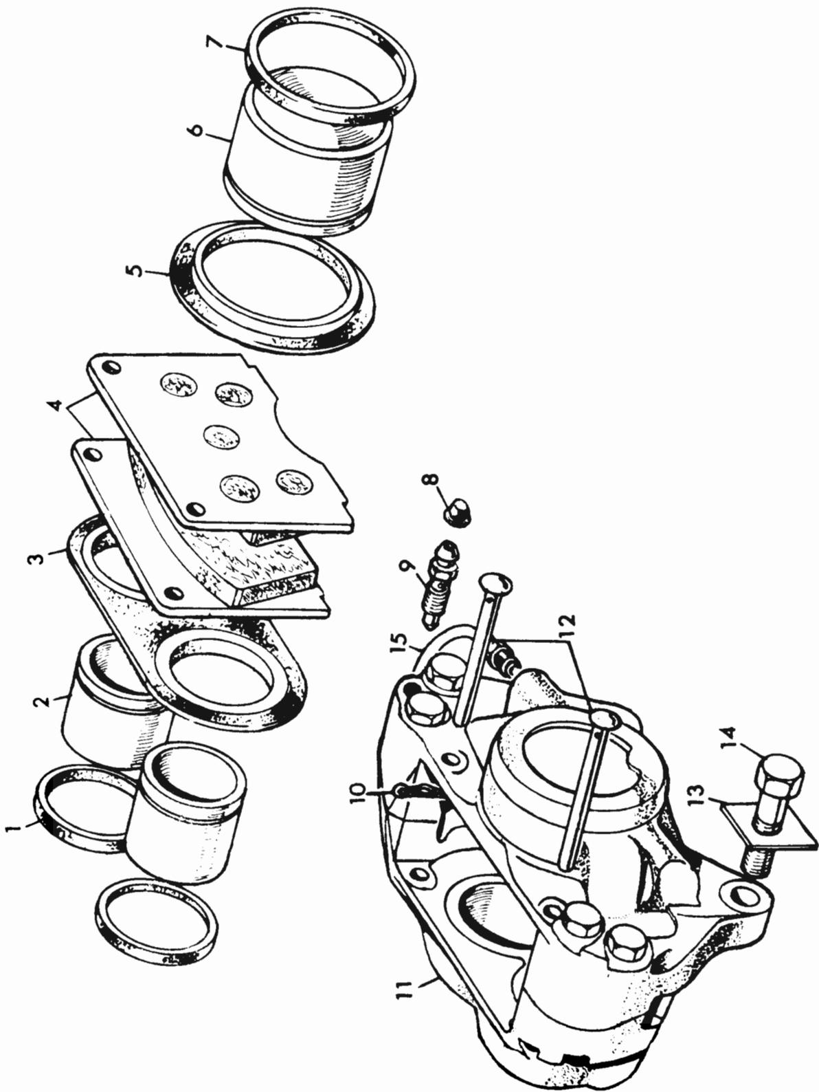
Fig. G.18 FRONT BRAKE UNITS
